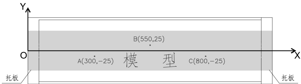
附图 9 悬挂点示意图 (大学组) (单位: mm)
